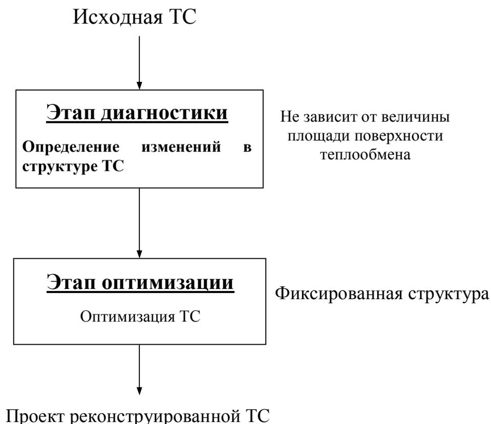
Рис. 7.50. Блок-схема комплексного алгоритма оптимальной реконструкции ТС
